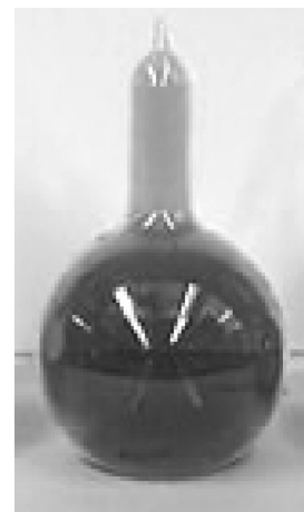
Matràs de fons rodó amb una mescla en equilibri de NO 2 i N 2 O 4 .
